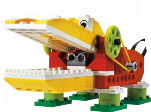
Bilder: BeeBot-Apps für iOS, Beispiel für einen WeDo 2.0 Roboter: Krokodil mit Abstandssensor, beißt bei Fütterung zu
